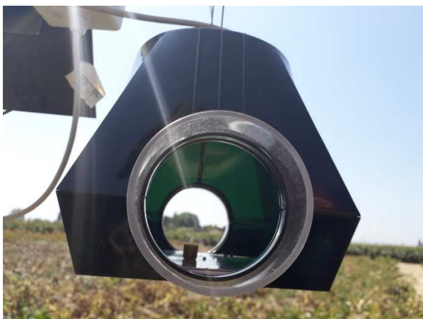
La trappola elettronica iScout
